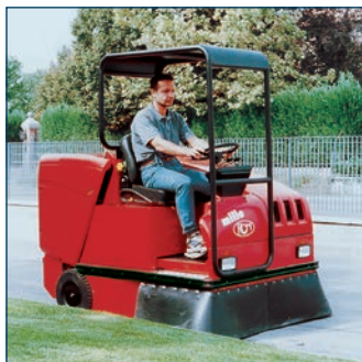
Bestuurderskap, werklichten en stofgeleider / Toit de protection, feux et convoyeur de poussière
