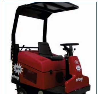
Afdak Toit de protection
